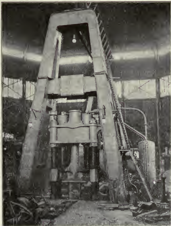
PRESSA IDRAULICA DA 5000 TONNELLATE DI POTENZA.
